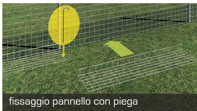
recinzione Mastertec h 180 cm interrata - esempio installazione tipo
