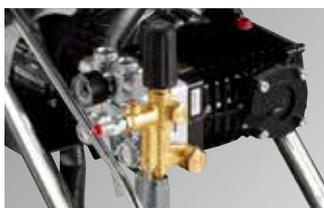
Nuove pompe CL3.8 e CL 6.0 autoadescentanti a tre pistoni in ceramica integrale, doppio visore olio e testata in ottone. Nuova valvola di regolazione pressione flangiata L3.1, passaggi interni ridimensionati per garantirne il corretto funzionamento anche in condizioni di alte portate d'esercizio
